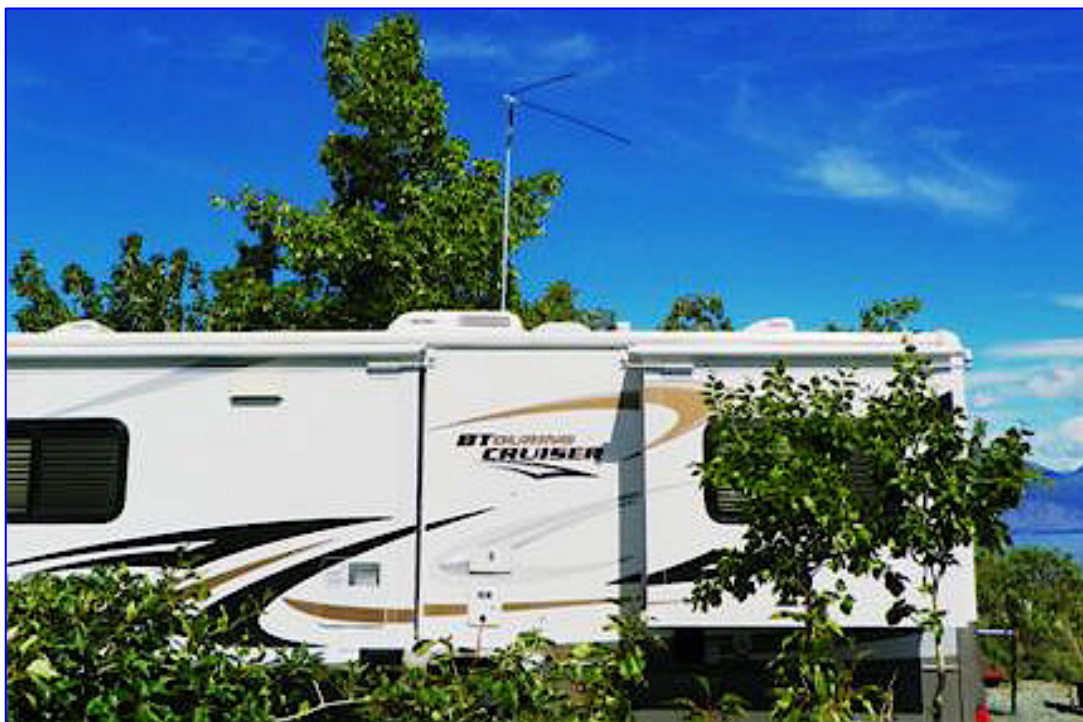
Κεραία Vee – Beam εγκατεστημένη σε τροχόσπιτο.
