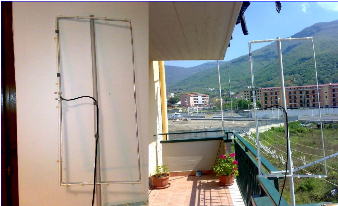
VHF – ΜΟΧΟΝ(2m) κατασκευασμένη και τοποθετημένη στο μπαλκόνι με κατακόρυφη πόλωση.
