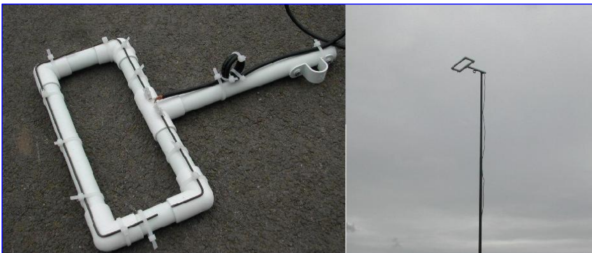
UHF – ΜΟΧΟΝ κατασκευασμένη σε πλαστική σωλήνα! και οριζόντια πόλωση.
