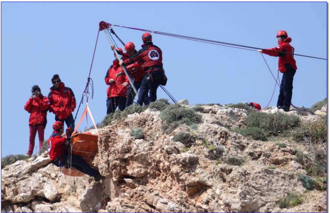
Χρήση διασωστικού βαρούλκου σε απόκρημνη ακτή.
